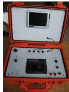
Figura 3 Pannello distribuzione gas comunicazioni e Consolle Video
